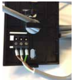
2. Swipe indien de kabel niet aangesloten is, open met een schroevendraaier de behuizing en sluit bruine, witte en groene draad aan volgens afbeelding. Au cas ou le cable n'est pas branché, utiliser un tournevis pour ouvrir le boîtier et brancher les fils brun, blanc et vert selon l'image
