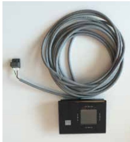
2. Swipe indien de kabel niet aangesloten is, open met een schroevendraaier de behuizing en sluit bruine, witte en groene draad aan volgens afbeelding. Au cas ou le cable n'est pas branché, utiliser un tournevis pour ouvrir le boîtier et brancher les fils brun, blanc et vert selon l'image
